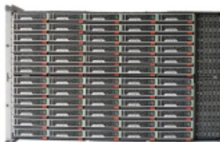
cVector向量计算一体机采用5U标准机架式结构，单台设备相当于60台普通服务器的处理能力。相比传统机架服务器，该向量计算一体机能够在同一机柜部署多达300个处理节点，并通过分布式处理资源管理系统形成一个统一处理资源集群，实现单个机柜处理35亿特征值秒级比对能力。针对英特尔CPU做了相应的性能优化，充分释放了CPU的计算性能，大大提升了各计算节点的计算速度。
