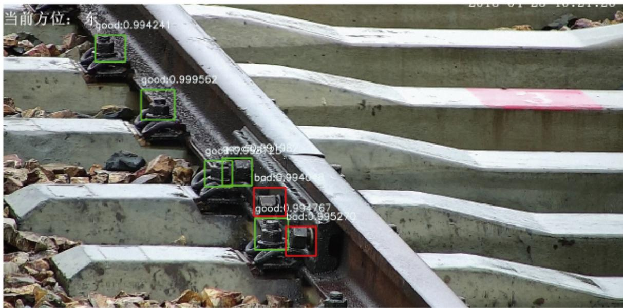
通过视频巡检与人工巡检相结合，实现轨道线路全天不间断巡检，并结合图像自动分析与预警信息推送，及时消除隐患，保证列车行驶安全。目前，轨道交通安全保障总体准确率已达到95%以上。
